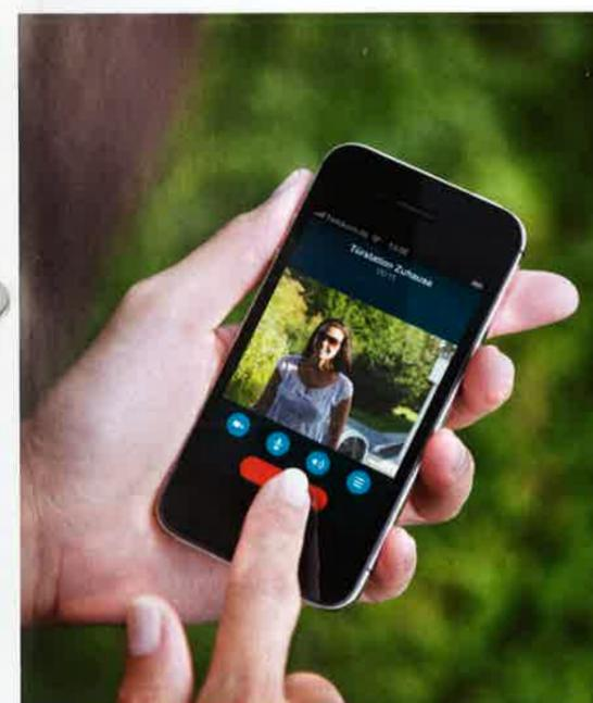
**DANK EINER ANBINDUNG AN SKYPE** werden Bild und Ton der Türkommunikation auch auf mobilen Geräten angezeigt. So können die Bewohner aus der Ferne mit dem Klingelnden sprechen und die Tür öffnen.
