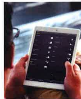
Bild 2: Über ein KNX System sind alle Komponenten der Haustechnik miteinander vernetzt. Funktionen wie Beleuchtung, Jalousien und Heizung können zentral am Tablet oder Smartphone bedient werden.
